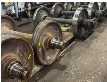
Рисунок 2 – Применение RFID-меток в вагоноремонтном депо [ https://goo.su/x55H9w ]
